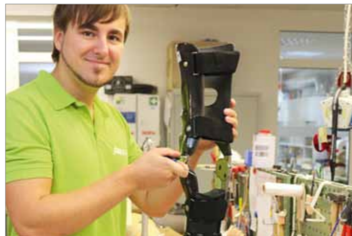
Feinjustieren einer Carbonorthese.
