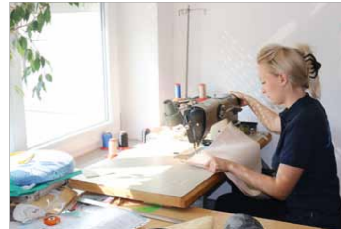
Nähen einer maßgefertigten Leibbinde an der Nähmaschine
