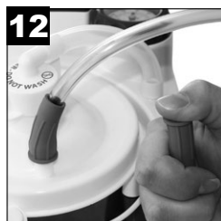
12 Bekreft sugenivået. MERK – Kontroller alltid sugenivået før du begynner ved å åpne enden av pasientslangen mens du observerer måleren. Still bryteren til ønsket nivå.
