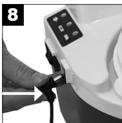
8 Hvis du bruker vekselstrøm og likestrøm, plugg den lille pluggen i DC-inngangen på siden av enheten.
