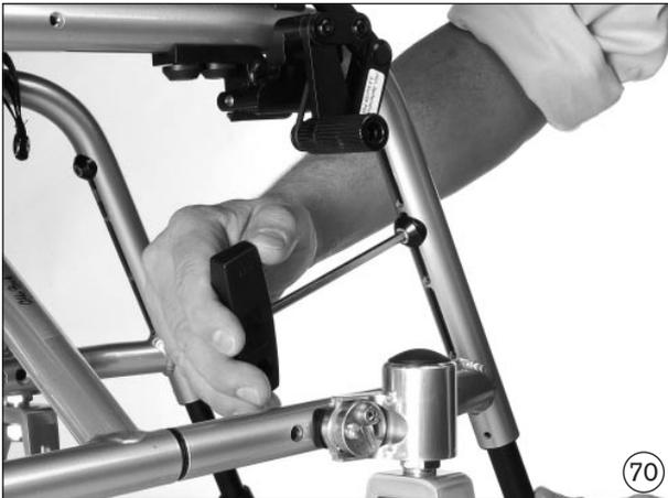
**Höhenverstellung der Fußraste Avantgarde T, Ti 8.9 und Ti Ultra**
