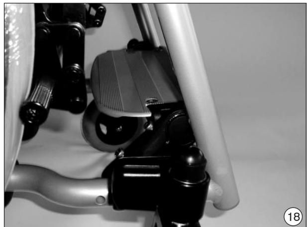
**Fußraste für kurze Unterschenkel­längen für Unterschenkel­längen von 16 bis 31 cm**
