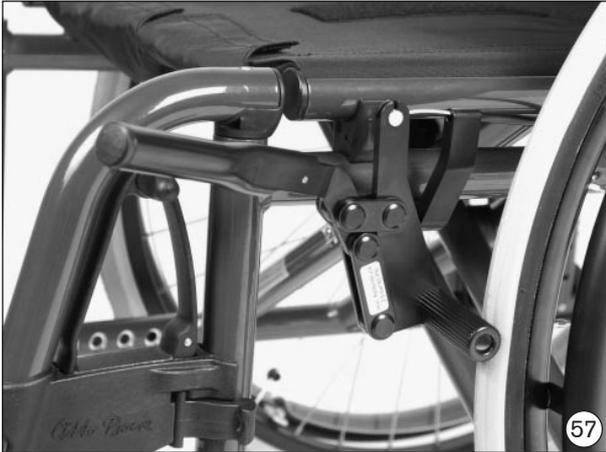
**Kniehebelbremse für Einhandbedienung** empfiehlt sich besonders für Hemiplegiker. Sie ist rechts oder links bedienbar und garantiert durch ein Zugsystem ein sicheres Feststellen beider Antriebsräder.
