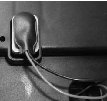
9-V-Blockbatterie für die Notabsenkung
