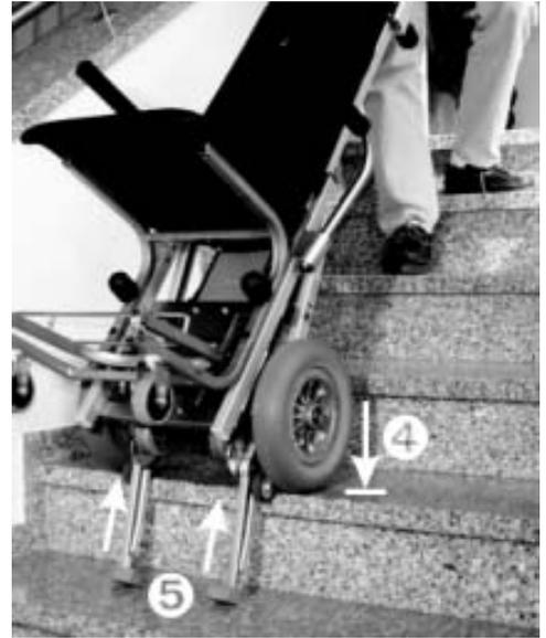
Wurde zu Beginn die Einzelstufenschaltung eingeschaltet, endet hier der Steigvorgang. Um weiter zu steigen betätigen Sie dann erneut den AUF/AB-Schalter in Richtung AUF.
