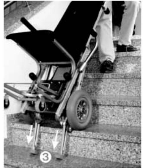
Nachdem die Steigbeine die untere Treppenstufe erreicht haben ④, übernehmen die Steigbeine die Last von den Laufrädern und die Laufräder und das Gestell werden von der oberen Treppenstufe leicht angehoben ⑤ und im weiteren Ablauf vom Bediener weg, Richtung Treppabwärts bewegt.
