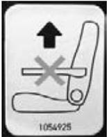
SCOOTER nicht über Armlehnen oder Beinstützen anheben. Abnehmbare Teile sind nicht zum Tragen geeignet.
