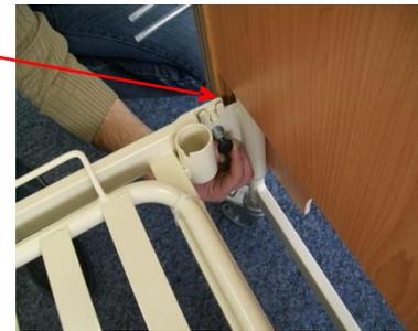
Beim Verriegeln der Zugschnäpper achten Sie besonders darauf, dass der Einrastbolzen in die dafür vorgesehene Bohrung eingerastet ist.
