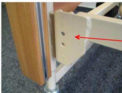
**Der Bolzen des Zugschnäppers muss sicher in der Bohrung eingerastet sein!**
