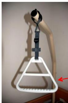
**Achtung:** Die Schlaufe des Triangelgurtes nur zwischen diesen beiden Bolzen fixieren!
