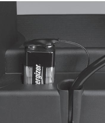
*9-V-Blockbatterie für die Notabsenkung*
