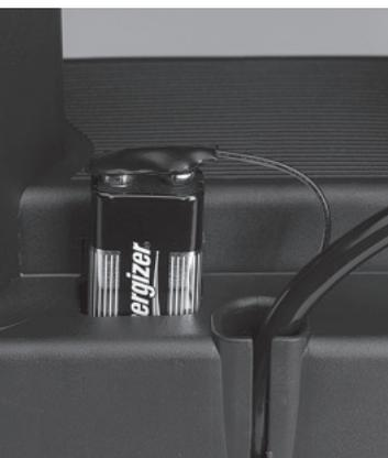
*9-V-Blockbatterie für die Notabsenkung*
