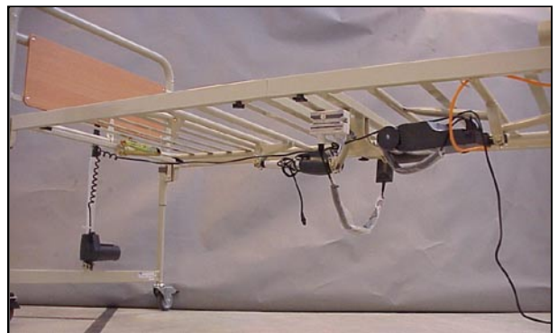
4. Motorkabel zum Fußteil muss am Haken des Beinteils aufgehängt werden! Der Rücken muss oben sein.
