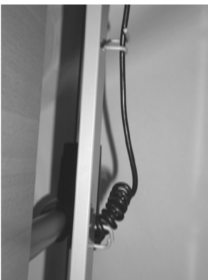
Leitungsführung Hubmotor, Kopfende..
