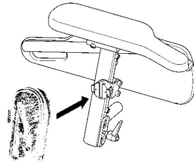
Der Adapter läßt sich in 90°-Schritten drehen. Dadurch haben Sie vier Einschubrichtungen zur Auswahl. Sehen Sie die Installationsanleitung, die Sie bei Ihrem Invacare®-Fachhändler oder direkt bei Invacare® erhalten.
