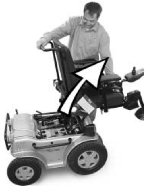
Das Bild unten zeigt die Position der Stange, die das Einstellen des Sitzwinkels ermöglicht.
