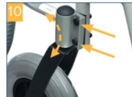
**Schrauben nach Einstellung unbedingt fest anziehen und den sicheren Halt überprüfen!**
