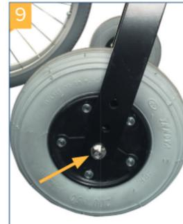
Die Stopfen der entsprechenden Bohrungen sind leicht austauschbar. Versetzen Sie das Rad nun in die gewünschte Position und stecken Sie die Radachsenmutter wieder ein und ziehen diese fest (Bild 9).
