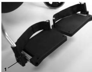
Durch Lösen der Schraube (1) kann das Fußbrett nach vorne und hinten verstellt werden. Achten Sie darauf, dass nach den Umbauarbeiten alle Schrauben fest angezogen sind (siehe Seite Anzugsmomente). Achten Sie darauf, dass Sie den Mindestabstand (2,5 cm) zum Boden einhalten.
