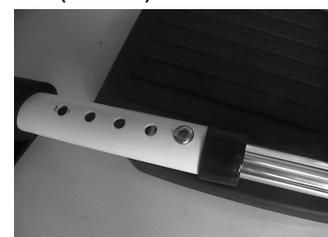
Bild 9: Schraube anziehen
