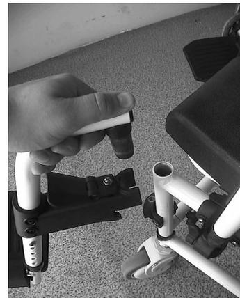
Bild 6: Rahmenrohrloch
