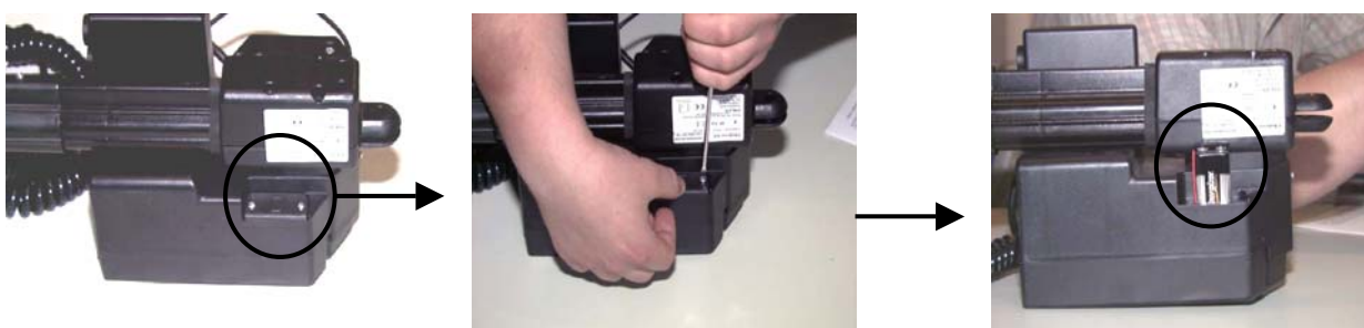
Afb. 25: Vervisselen van de backup-batterij
