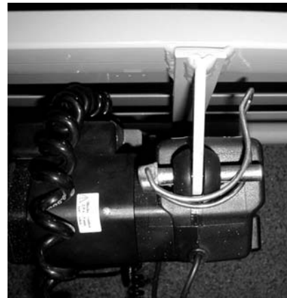
Figura 24: fissaggio dei motori
