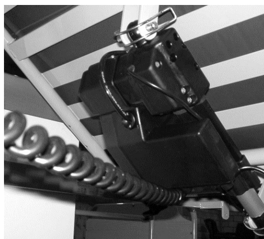
Afb. 14: Aanleg van de kabel voor de netaansluiting
