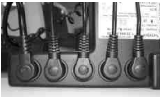
Figura 11: allacciamento corretto di motori e interruttore manuale NON COSÌ
