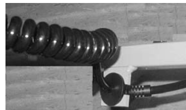
Figure 15: Décharge de tension pour le câble d'alimentation
