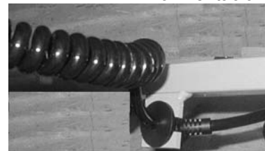
Figura 15: Compensación de tracción cable para la alimentación
