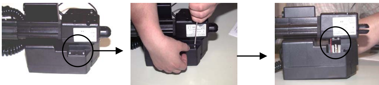
Figure 25: Changement de la pile de secours
