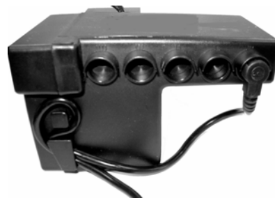
Afb. 12: Trekontlasting voor de handschakelaarkabel
