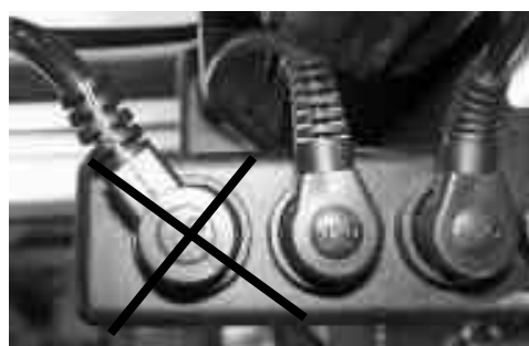
Figura 11: allacciamento corretto di motori e interruttore manuale NON COSÌ
