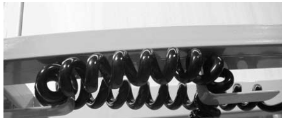
Figura 16 : Sistema anti-trazione del cavo di attacco al alla presa di corrente
