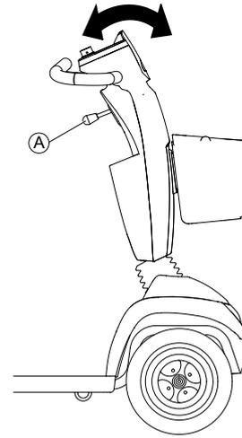
1. Zum Einstellen der Lenksäule den Hebel Ⓐ nach unten drücken.
