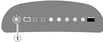
Die AN/AUS-Diode (1) dient als Störungsanzeige (Statusanzeige). Sie blinkt, wenn am Scooter ein Problem auftritt. Die Anzahl der Blinkvorgänge gibt die Art der Störung an. Siehe 11.1.2 Fehler- und Diagnosecodes, Seite 62.
