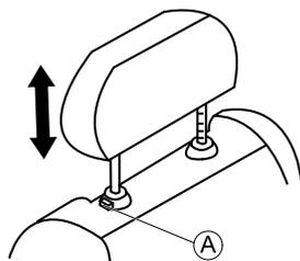
1. Zum Anheben der Kopfstütze den Entriegelungsknopf Ⓐ drücken und die Kopfstütze nach oben in die gewünschte Position ziehen.
