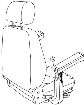
1. Die Befestigungsschraube der Armlehne **A** lösen und entfernen.
