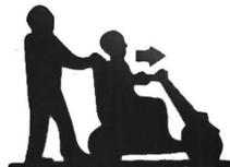
Dieses Symbol kennzeichnet die Position „Push“ (Schieben) des Kupplungshebels. In dieser Position ist der Motor ausgekuppelt und die Motorbremsen sind außer Funktion. Das Elektrofahrzeug kann von einer Begleitperson im Freilauf geschoben werden.
