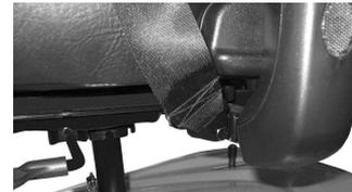
Schritt 1–2 auf der anderen Seite des Sitzes mit der zweiten Seite des Haltegurts wiederholen. Überprüfen Sie den korrekten und sicheren Sitz der Mutter an dem Bolzen.
