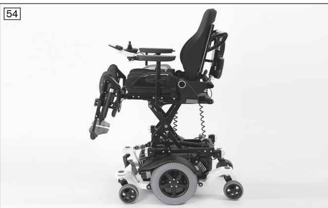
Durch die elektrische Sitzhöhenverstellung wird die Sitzfläche über einen Motorantrieb um **350 mm (13,8")** angehoben.
