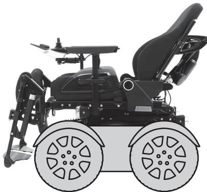
Die elektrische Rückenwinkelverstellung ermöglicht ein Neigen der Rückenlehne um bis zu **30°**.
