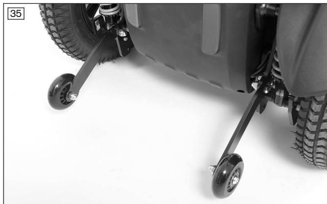
Der Kippschutz macht das Fahren sicherer (siehe Abb. 35). Er verhindert bei einem Heckantrieb das Abkippen des Rollstuhls nach hinten.
