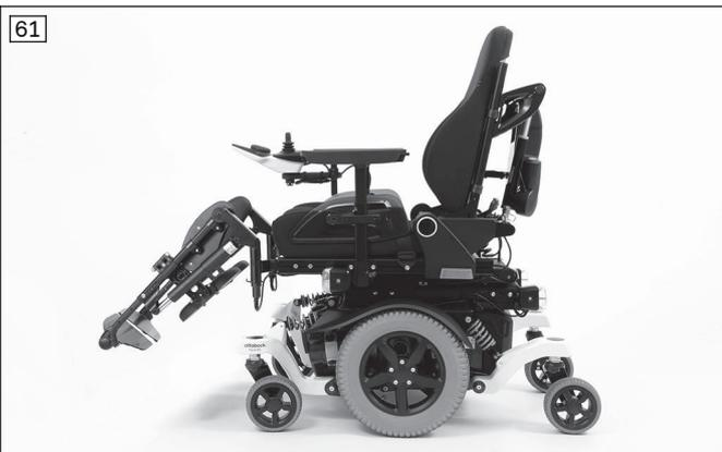
Die Beinstützen dienen dazu eine dauerhafte Druckbelastung zu vermeiden oder eine Antischocklagerung zu gewährleisten.
