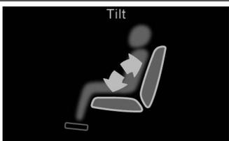
Tilt<br>Das Diagramm zeigt einen elektrischen Rollstuhl mit zwei schrägen Pfeilen, die nach hinten und vorn zeigen.        | Elektrische Sitzkantelung                                                                                                                     | Nach hinten: Sitz kippt langsam nach hinten<br>Nach vorn: Sitz kippt langsam nach vorn in die Waagerechte                                        |
