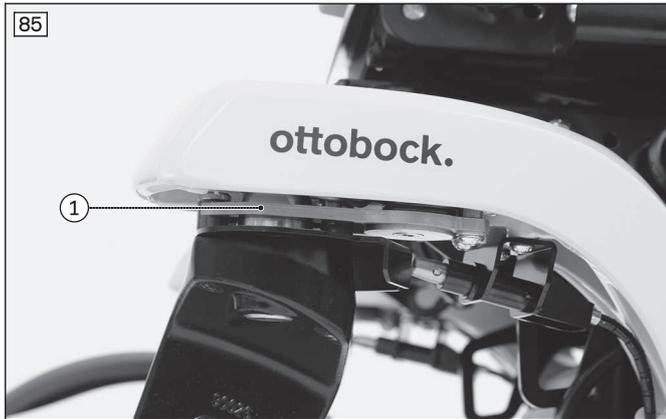
Die mechanische Spurstabilisierung (siehe Abb. 85, Pos. 1) stabilisiert unterhalb der Lenkradschwinge die Lenkräder in der schnellen Vorwärtsbewegung. Dadurch wird bei Geradeausfahrten (z. B. im Straßenverkehr) die Spur besser gehalten.
