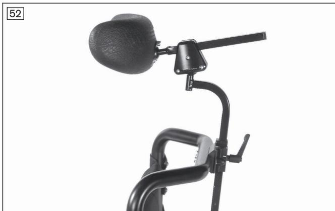
Das Montageset dient der Aufnahme von Kopf-/Nackenstützen. Es wurde mit Hilfe eines Adapters am Rückenrahmen montiert.
