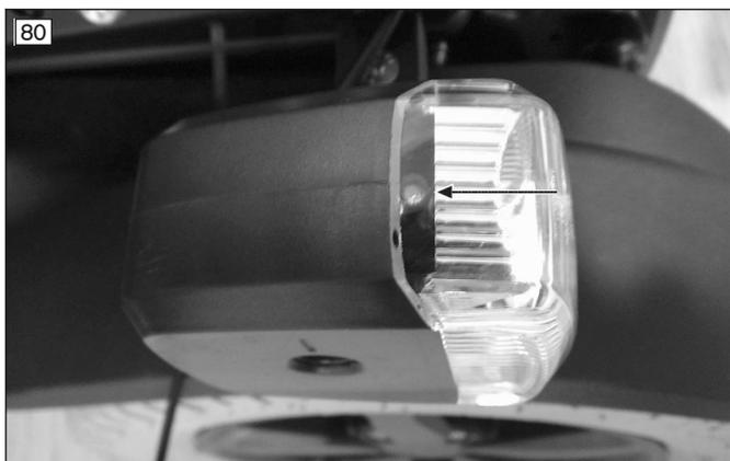
Der integrierte Dämmerungssensor (siehe Abb. 80, Pfeil) bewirkt, dass sich bei eingeschalteter Steuerung die Beleuchtung je nach Außenhelligkeit selbständig ein- und ausschaltet.
