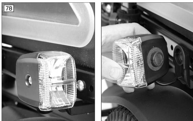
Die Frontbeleuchtung besteht aus 2 Frontleuchten mit integrierten Blinkern (siehe Abb. 78, links).
