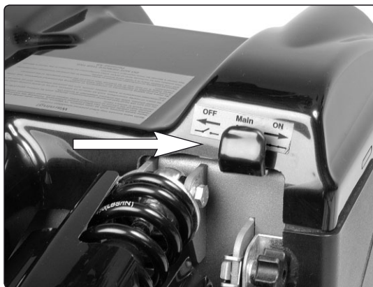
Hauptsicherung in Position "EIN" (ON)
