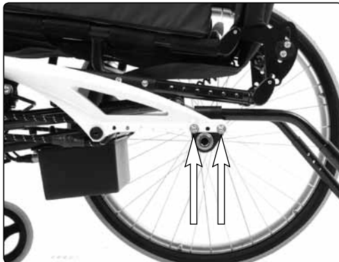
Die Radhalterung wird mit zwei Schrauben fixiert.
