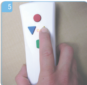
5. Wenn nun die Auf-Taste gedrückt wird, hört man das Relais in der Handsteuerung klicken!
