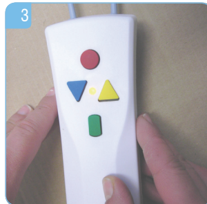
3. Der Testmode beginnt, zuerst leuchtet die LED grün!
