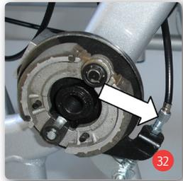
Um eine optimale Bremswirkung zu erreichen, wird die Bremskraft an der Einstellschraube justiert. Die Bremskraft wird durch Herausdrehen der Einstellschraube (Pfeil) verstärkt und durch Hineindrehen verringert. (Abb. 32)
