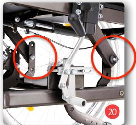
Platzieren Sie die Gasdruckfeder in die entsprechende Bohrung unter dem Sitz und ziehen Sie die Schraube an.
