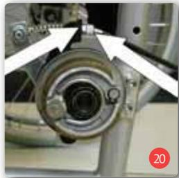
Um eine optimale Bremswirkung zu erreichen, wird die Bremskraft an der Einstellschraube justiert (Abb. 20). Die Bremskraft wird durch Herausdrehen der Einstellschraube verstärkt und durch Hineindrehen verringert.
