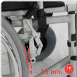
Der S-Eco 300 ist mit einer Reifenbremse, die für den Insassen bedienbar ist, ausgestattet. Diese ist nur zum Parken zu verwenden. Zum Abbremsen der Fahrt ist diese nicht geeignet! Hierzu dienen die Greifreifen, auf die mit den Handflächen leichter Druck ausgeübt wird. Wenn der Rollstuhl auf diese Weise abgebremst wurde, betätigen Sie beide Reifenbremsen durch nach-vorn-drücken der Bremshebel. Der Rollstuhl steht nun sicher gebremst.
