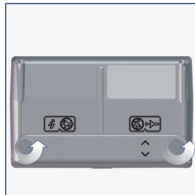
Schaltleiste drehen und einsetzen.
