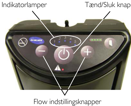
FIGUR 6.9 Justering af puls flow indstilling
