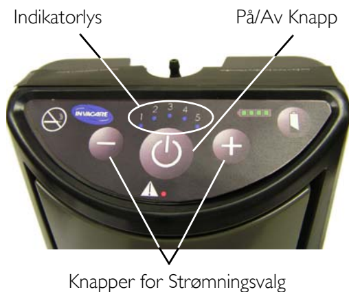
FIGUR 6.9 Justering av strømningsinnstillingen for puls
