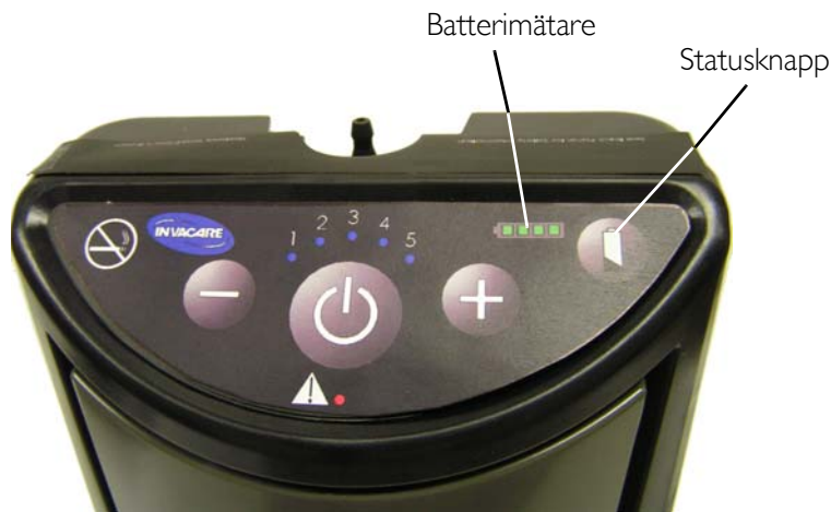
FIGUR 6.2 Att kontrollera nivån på det inbyggda batteriet
