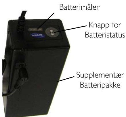
FIGUR 6.4 Lading av kun det Supplementære Batteriet
