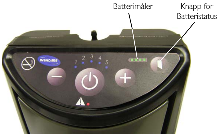
FIGUR 6.2 Kontroll av Ladenivået av det Interne Batteriet
