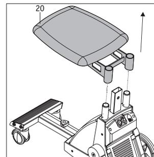
**!** Greifen Sie beim Transport des scalacombi niemals an oder in die Räder des Gerätes. Halten Sie das scalacombi beim Transport, wie oben beschrieben, ausschließlich an den überstehenden Rechteckrohren fest. Um das versehentliche Einschalten des Gerätes bei einem Transport zu vermeiden, muß zusätzlich der Stecker [12] aus der Aufnahme [11] an der Bedienkonsole abgezogen werden.
