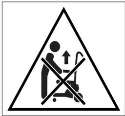
Heben Sie das Gerät nicht an den Armlehnen an, insbesondere nicht mit einer zu befördernden Person sitzend im scalacombi. Die Armlehnen sind aus benutzerfreundlichen Gründen dreh- und entnehmbar ausgeführt (z.B. für den Transfer auf den Sitz des scalacombi) und können sich bei Zug nach oben je nach Kräftrichtung unbeabsichtigt lösen.
