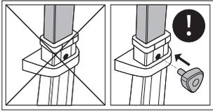
Das scalacombi darf nur dann betrieben werden, wenn das Handrad für die Griffenheit [16] in das Standrohr [15] und das Handrad [13] in die Antriebsseinheit [6] eingeschraubt ist. Die Griffenheit [18] ist dadurch fest mit dem Antrieb des scalacombi verbunden.
