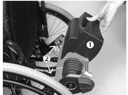
☞ Setzen Sie den max-e mit seinen Rollstuhlverbindungen **1** in einer geraden Linie zur Halterung **2** an.
