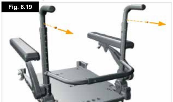
4. Die 4 mm Schrauben für den Rückenbügel und den Rückenbügel abnehmen, (Fig. 6.20).
