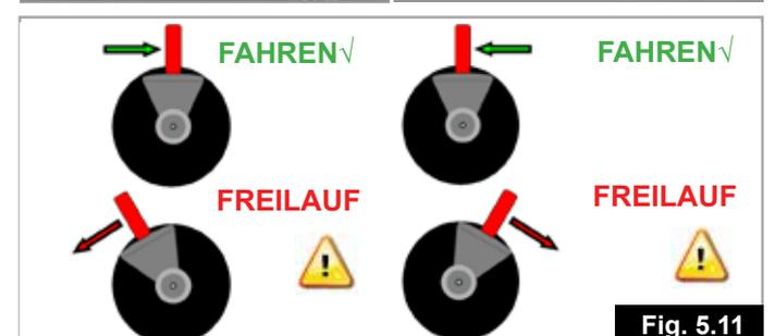
Bitte achten Sie darauf, dass die Steuerung ausgeschaltet ist, bevor Sie die Entriegelungshebel betätigen - geschieht dies nicht, muss zum Schieben des Rollstuhls wesentlich mehr Kraft aufgewendet werden.
