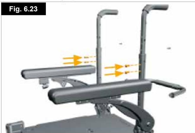
8. Wenn der Rückenbügel Schritt 4 abgenommen wurde, den Rückenbügel und die Schrauben wieder anbringen. Arbeiten Sie mit einem Drehmoment von 10 N/m (Fig. 6.24).
