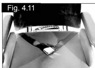
Die Gurtenden mit den Halterungen wie abgebildet durch das untere Befestigungsloch unter die Querstrebe einführen. Vergewissern Sie sich, dass die Schnallen zugänglich sind und der Gurt nicht verdreht ist. (Fig. 4.12).
