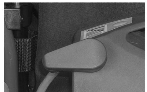
Danach wird der Stecker ❶ der Powerleitung in die Ausgangsbuchse ❷ am Akkupack eingesteckt.
