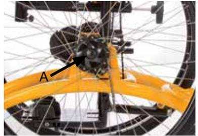
Gegen ein ungewolltes Wegrollen und für einen sicheren Stand ist der Stehtrainer mit Trommelbremsen an den Antriebsrädern ausgestattet.
