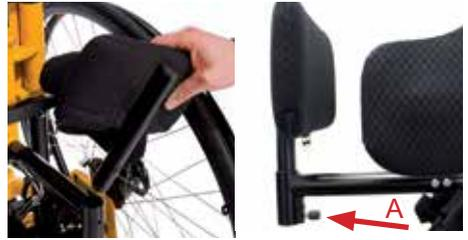
Zur Einstellung der Höhe nehmen Sie bitte den Bezug von der Gesäßpelotte, lösen leicht die Innensechskant-Schrauben an der Rückseite (B) und bringen die Gesäßpelotte in die gewünschte Position. Darüber hinaus lässt sich die Höhe auch über die Höhenverstellung an der Mittelsäule (siehe Punkt 3.2) einstellen.
